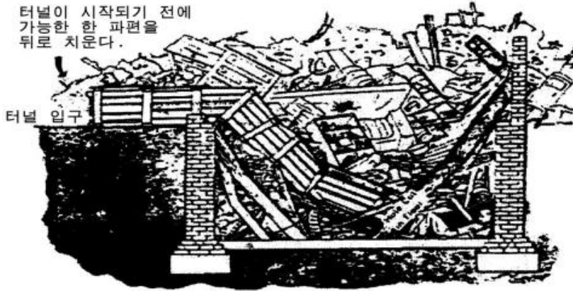
[ 그림 4-54 ] 바닥을 따라 터널 뚫기 및 빈공간 진입
