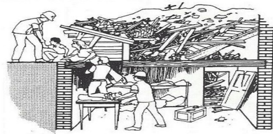
[ 그림 4-55 ] 터널 뚫기 방법에 의한 인명구조
