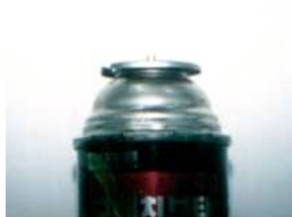
[ 그림 1-63 ] 압력상승에 의한 용기팽창 (RVR 설치 접합용기)
