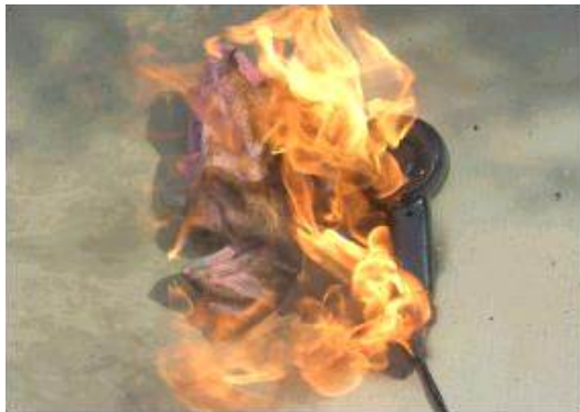
[ 그림 5-38 ] 헤어드라이기를 이용한 전기위장 화재 재현
