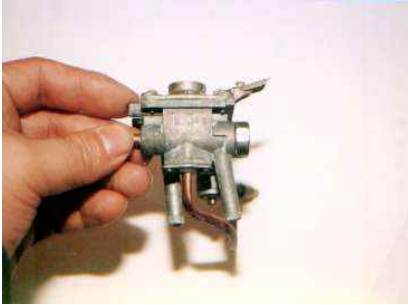
[ 그림 1-58 ] 용기자동이탈식 안전장치가 장착된 거버너
