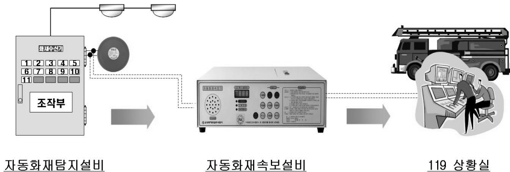
[그림 2-73] 자동화재속보설비 작동 구성도
