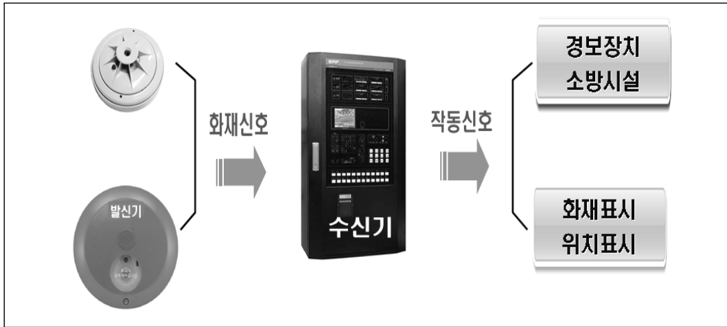
[그림 2-1] 자동화재탐지설비의 작동흐름도
